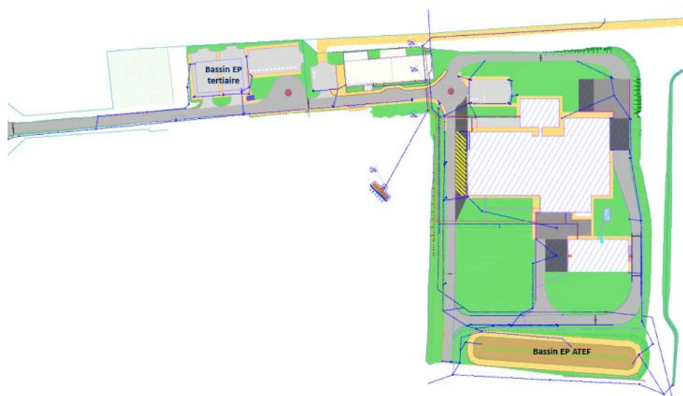
Figure 6 : Plan d'implantation des bassins de l'installation ATEF
